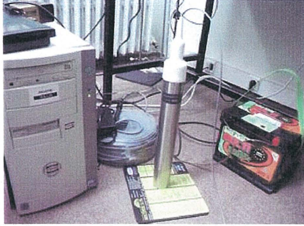
Şekil 3. Toprak radon gazı hareketinin izlenmesinde kullanılmakta olan ölçüm sistemi (AlphaNuclear Co, Model 611) ve parçaları. Ölçüm cihazı 15 dakika aralıklar ile veri kaydetmektedir
