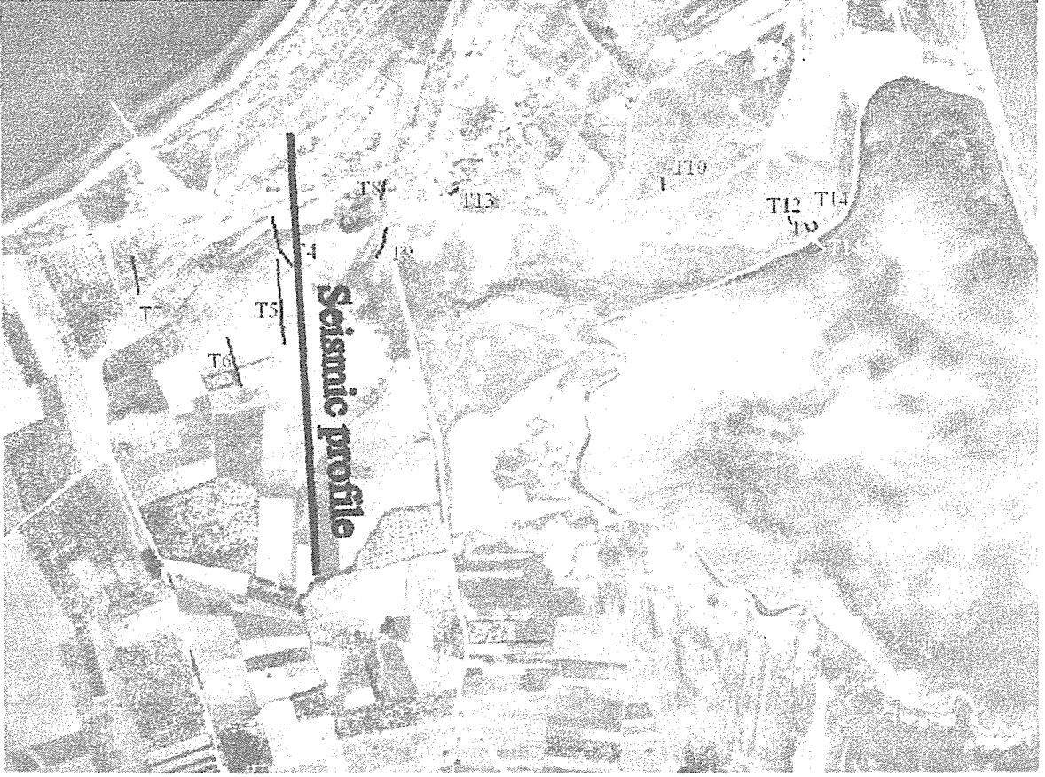
Şekil 7 Çalışma alanında yapılan fay kazıları ve jeofizik profilin hava fotoğrafı üzerinde gösterimi.
